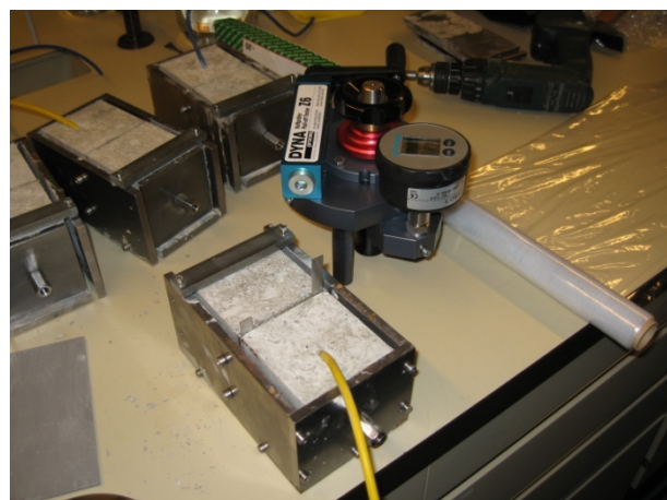
Abb. 3.8 (links) Rissbildung mittels Haftzugprüfgerät
