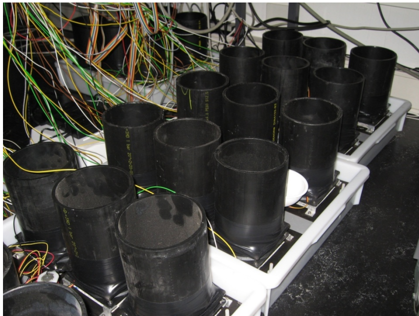
Abb. 3.5 Abluftrohre über den Probekörpern um die mit Feuchtigkeit angereicherte Luft nach oben abführen zu können
