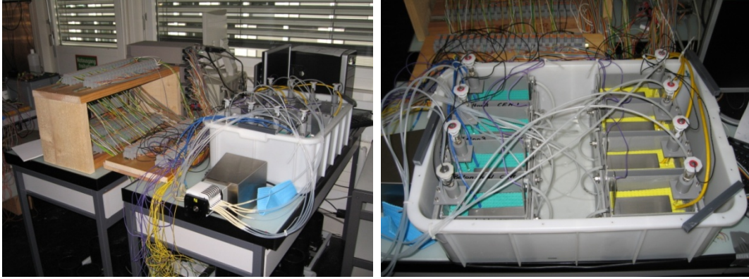
Abb. 3.11 (l) und 3.12 (r) Aufbau Durchflussversuch an gerissenen Betonkörpern
