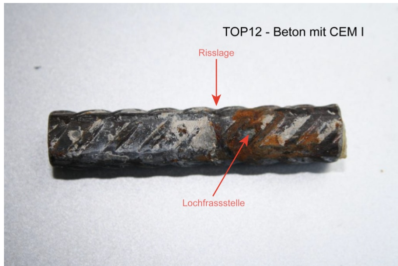
Abb. 4.8 Ausgebauter Top12-Stab nach dem Durchflussversuch
